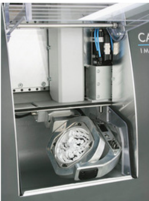
16개의 톨 체인저와 동시 5축 이 가능한 CAM5-S1 Impression 밀링 머신
