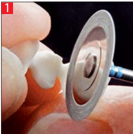
1 Bearbeitung von gehipptem Zirkondioxid. Trimming of hipped zirconium oxide. Façonnage d'oxyde de zircon du type HIP.
