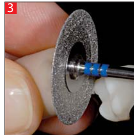
3 Durchtrennen von Presskanälen. Separation of moulded ducts. Taille de pointes de moulage.
