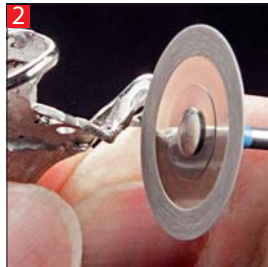
2 Bearbeitung von Modellguß. Trimming of metal framework. Façonnage du modèle moulé.
