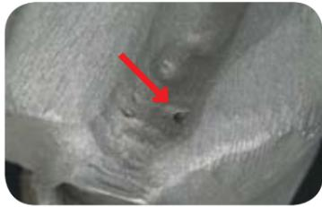
심한 킬팅으로 리메이크된 메탈을 이용하여 테스트하여 보았다. 두 곳을 잘라서 베라슬더를 이용하여 슬더한 후 테스트를 진행하였다. 메탈의 주조 상태가 매우 안 좋다. 두꺼운 부분이 많고 오버멜팅 되어 기포도 많이 보인다. 테스트의 의미로 무시하고 작업을 진행하였다.
