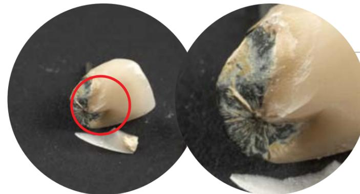
Crea Alloy Bond를 바르고 동일한 방법으로 파절 테스트한 모습이다. 절단기를 이용한 파절 테스트라 어느 한 부분에 힘이 전달되어 파절된 모양을 보인다. 비교적 메탈과 분리가 깔끔하지 않은 것으로 보아 충분한 화학적 결합을 이룬듯이 보인다.
