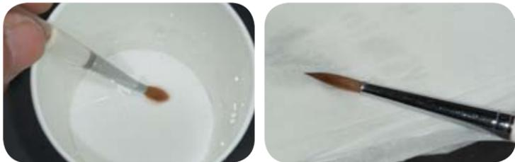
사용 할 붓은 미리 충분히 물에 담구어 두는 것이 좋다. 마른 붓을 사용 할 경우 페이스트가 쉽게 건조하여 바르기 어렵기 때문이다. 페이스트 형태의 Crea Alloy Bond는 기름 성분으로 물로 희석해서 사용하면 안된다. 페이스트 오펙과 마찬가지로 농도조절을 잘해야만 바르기 용이하다.
