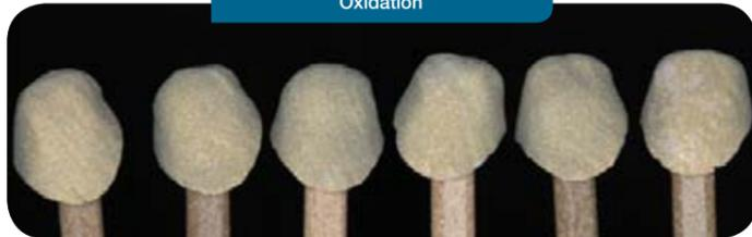
소성 후 Wash Opaque이 두꺼운 경우 가는 열구가 관찰된다. 두껍게 바름에도 Crea Alloy Bond는 소성 후에도 메탈빛의 완전 차폐는 되지 않았다. Wash Opaque (920도 소성) Crea Alloy Bond(980도 소성) 온도차이에 따라 표면의 성상이 차이를 보인다.
